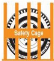
Después de que una llanta es instalada en la rueda, siempre utilice una jaula de seguridad que siga las directivas de la OSHA. Una vez que la llanta está en la jaula, puede ser inflada.
