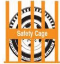
Après avoir installé le pneu sur la jante, placez-le toujours dans une cage de sécurité répondant aux exigences de l'OSHA. Une fois dans la cage, il est possible de gonfler le pneu.
